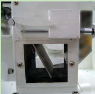
투입량 조절장치(수동) input volume controller
