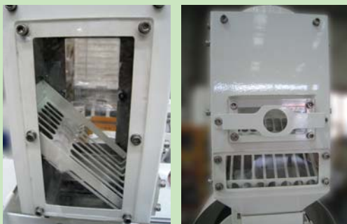
거름망 / 거름망내 투입량 센서부착 sorting mesh / input volume sensor
