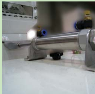
공급량 자동개폐장치 automatic gate of input volume
